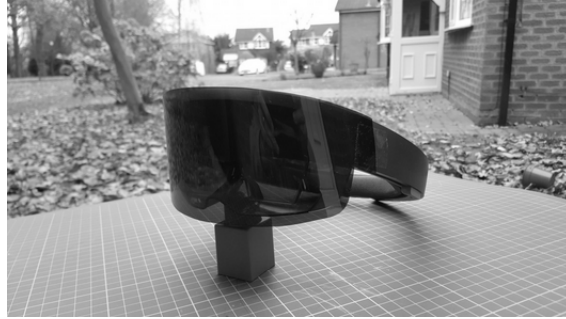
FIGURE 2.6 HoloLens 1.0 avec filtre de réduction lumineuse par Gaydhani [29]
