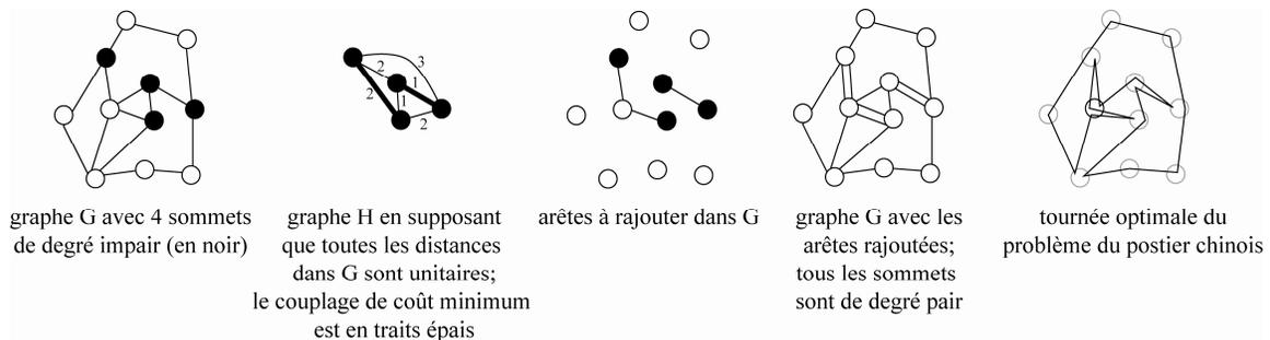
Dans l'exemple ci-dessus, on a supposé que toutes les distances dans  $G$  sont unitaires. Remarquons en passant que pour que le point 2 de l'algorithme ait un sens et qu'on puisse ainsi transformer tous les sommets de degré impair dans  $G$  en des sommets de
