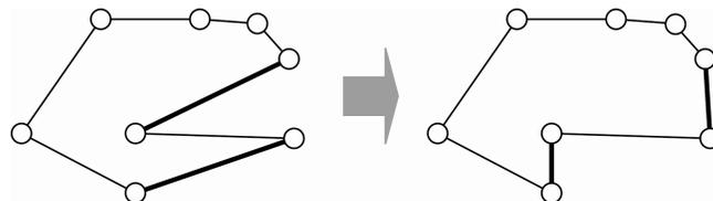
Cette procédure de post-optimisation permet de réduire considérablement l'écart à l'optimum. Par exemple, en comparant les solutions produites par le logiciel CONCORDE avec la combinaison de l'heuristique du plus proche voisin suivie d'une post-optimisation, on a pu constater que l'erreur est en moyenne d'environ 2 à 3%.
