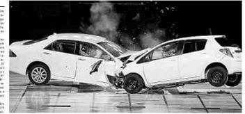
Un crash-test de sécurité effectué sur un véhicule pour évaluer l'efficacité des ceintures de sécurité.
