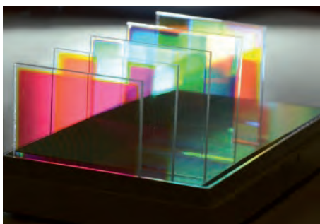
Filtres interférentiels constitués de matériaux diélectriques de bas et haut indice de réfraction ( SiO_2 et Ta_2O_5 ) déposés par pulvérisation par double faisceau d'ions. Les couleurs perçues sont purement dues à des effets d'interférence lumineuse.
