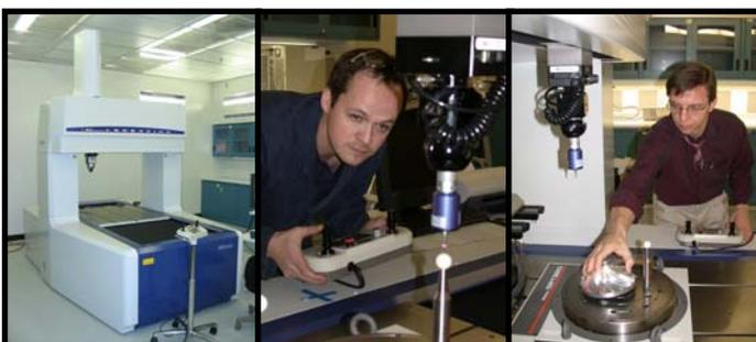
La Legex de Mitutoyo est la machine la plus précise sur le marché. Au Canada seul l'Institut des étalons nationaux de mesures a des installations similaires sauf que notre machine a un volume de travail plus grand pour la mesure de pièces industrielles.
