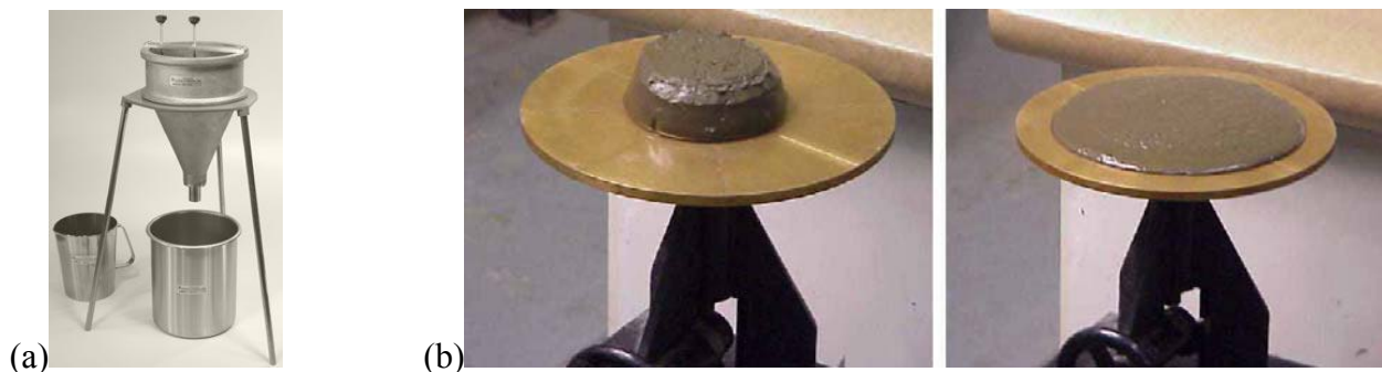
Figure 8. Test d'affaissement modifié : a) cône d'écoulement ( flow cone ) ; b) table d'écoulement ( flow table ).
