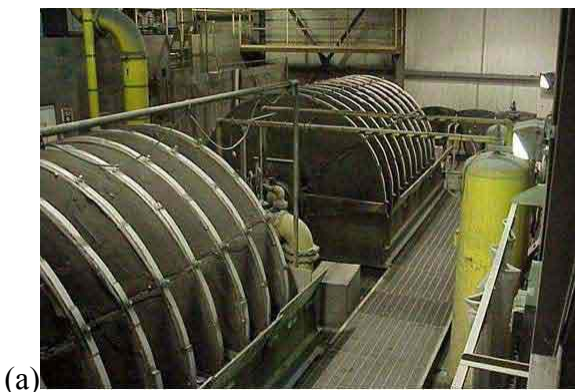
Figure 2. Composantes de l'usine de remblai en pâte : a) exemple de filtres à disque ; b) exemple de pompe à piston.
