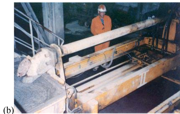
Figure 2. Composantes de l'usine de remblai en pâte : a) exemple de filtres à disque ; b) exemple de pompe à piston.
