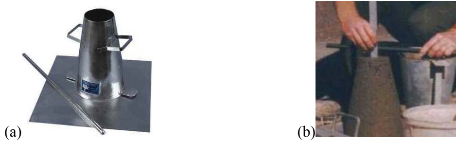
Figure 7. Consistance de la pâte par mesure d'affaissement : a) cône; b) principe de mesure de l'affaissement
