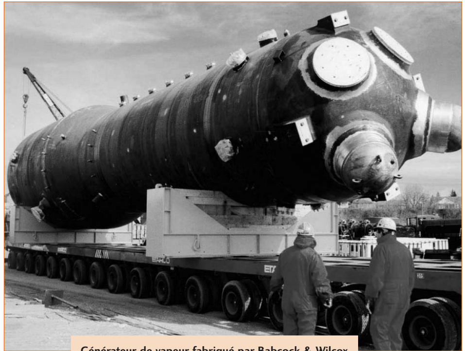
Générateur de vapeur fabriqué par Babcock & Wilcox
